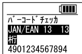
バーコードチェッカでは、照合をせずに、読み取ったバーコードの種別、桁数、データ内容（最大 32 桁まで）を表示します。
