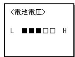
バッテリーの残容量目安が5段階で表示されます。
