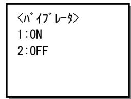
バイブルーターを ON にすると、ブザーの鳴動と共にバイブルーターが振動します。この設定はアプリケーションプログラムからブザーを鳴動させる時に有効です。
