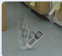
実運用に適した高い耐落下性能(コンクリート面1.5m)を実現。
