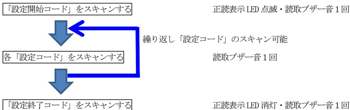
「設定コード」による機能設定は、「設定終了コード」をスキャンした時点で設定状態になり、設定状態を記憶します。(電源オフ状態または乾電池を外した状態でも設定を保持します)
