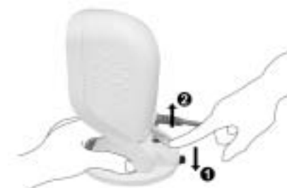
図3：レバーを押し下げて本体を固定します。
